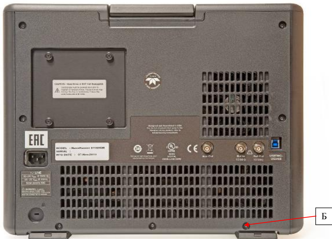
Рисунок 2 – Схема пломбировки от несанкционированного доступа (Б)
