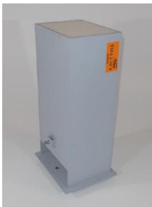
Рисунок 5 – Общий вид эталонной антенны ТМА 1-10 Э, диапазон частот (1-10) ГГц
