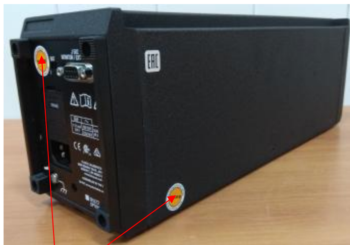
места нанесения пломб в виде наклеек
