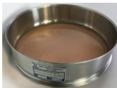
а) сита с просеивающей поверхностью из металлической проволочной сетки
