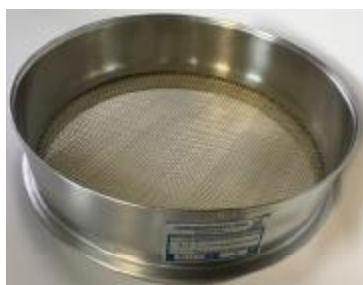
а) сита с просеивающей поверхностью из металлической проволочной сетки
