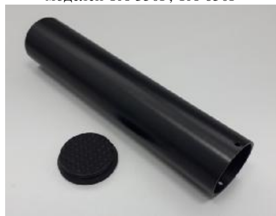
Рисунок 18 - Общий вид сменных вставок абсолютно черного тела для калибраторов моделей ТА-25NL, ТА-45NL, ТА-60NL
