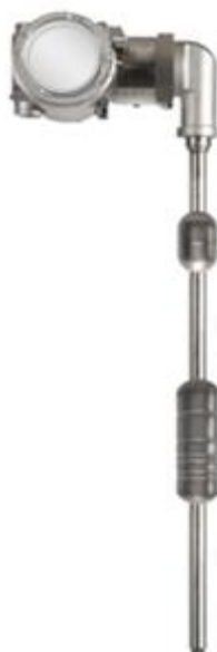
Уровнемер модификации LMT100 с ЭБ без показывающего устройства и поплавками для измерений уровня жидкости и уровня раздела сред
