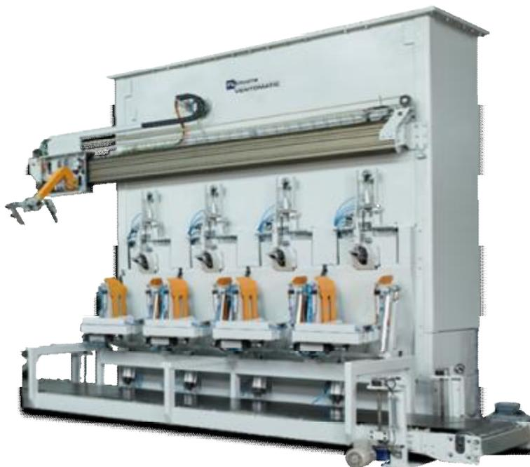
Рисунок 1 — Внешний вид автоматизированной системы дозирования линейной конструкции, пример с четырьмя ГПУ (узлами взвешивания))
