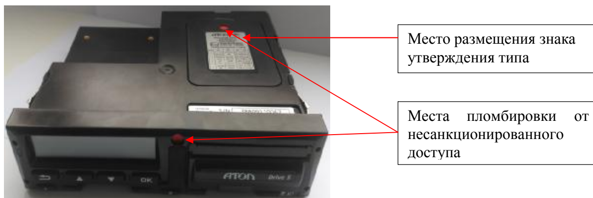
Рисунок 2 – Место размещения знака утверждения типа и схема пломбировки от несанкционированного доступа
