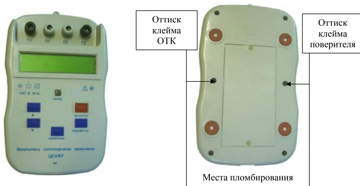
Рисунок 1 - Общий вид измерителей с указанием мест нанесения знака поверки и пломбирования от несанкционированного доступа
