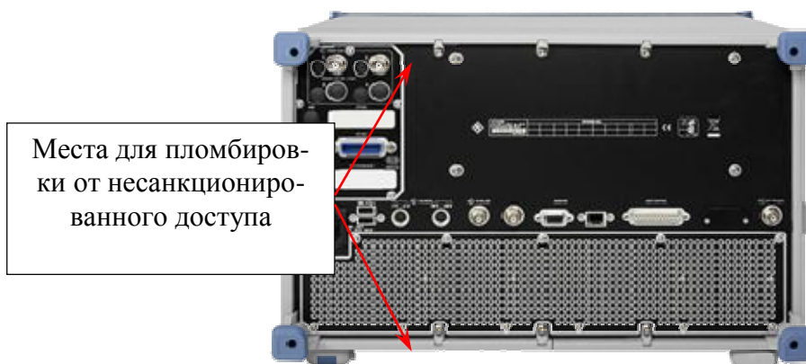
Рисунок 8 – Задняя панель ВАЦ с указанием мест пломбировки от несанкционированного доступа
