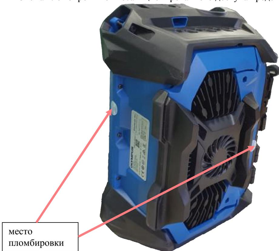
Рисунок 3 – Схема пломбировки от несанкционированного доступа
