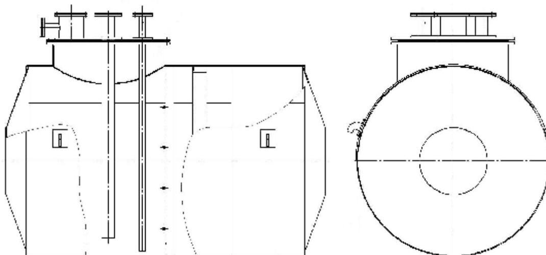
Рисунок 1 – Эскиз резервуаров стальных горизонтальных цилиндрических РГС-18, РГС-40
