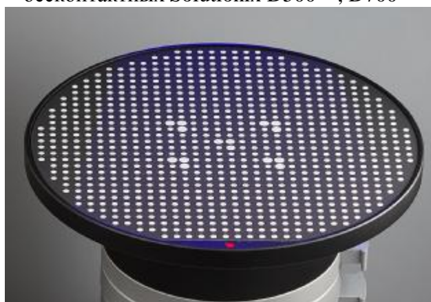
Рисунок 3 – Общий вид калибровочной пластины приборов оптических координатно-измерительных бесконтактных Solutionix D500™, D700™
