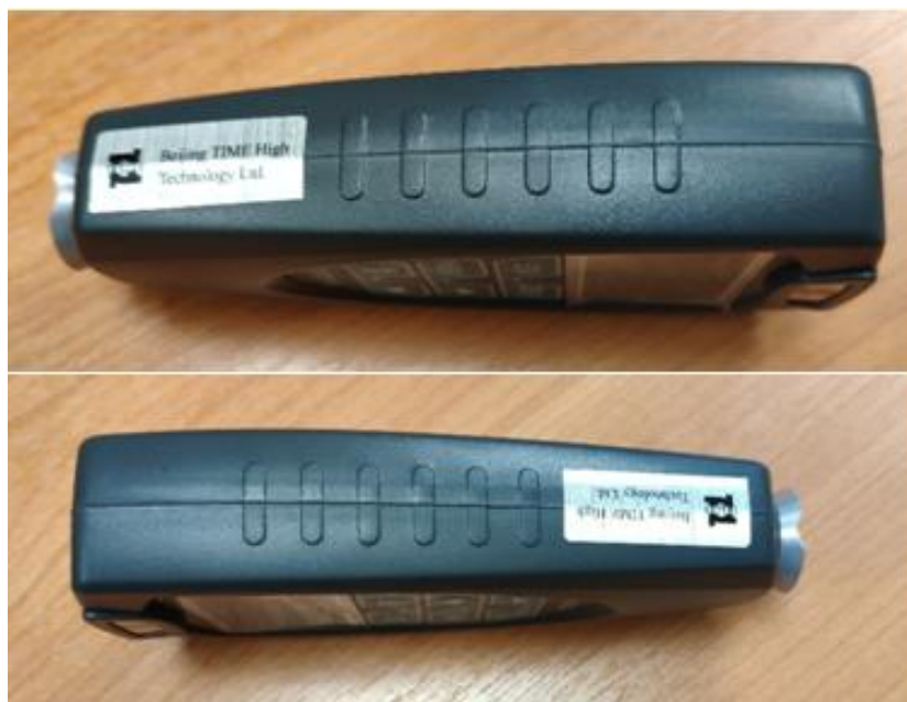
Рисунок 8 – Схема пломбировки от несанкционированного доступа
