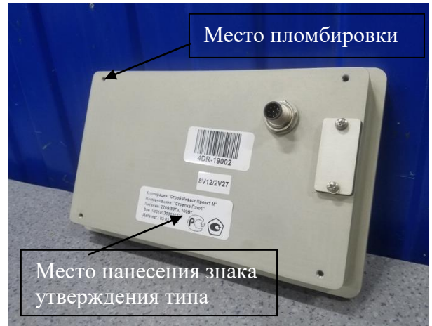
Рисунок 6 – Схема пломбировки и место нанесения знака утверждения типа на 4D модуль
