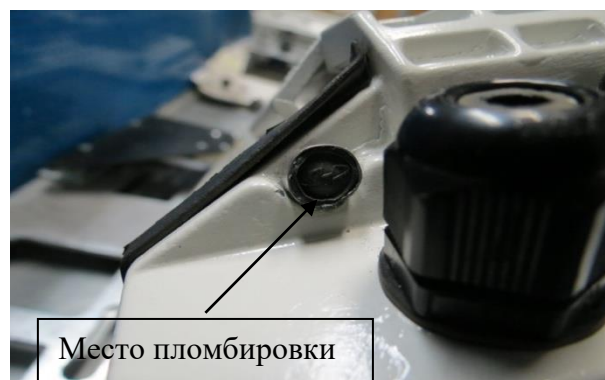
Рисунок 4 – Схема пломбировки видео модуля
