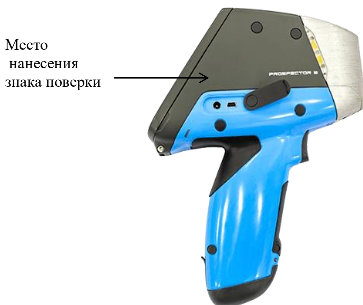
Рисунок 2 –Обозначение места нанесения знака поверки
