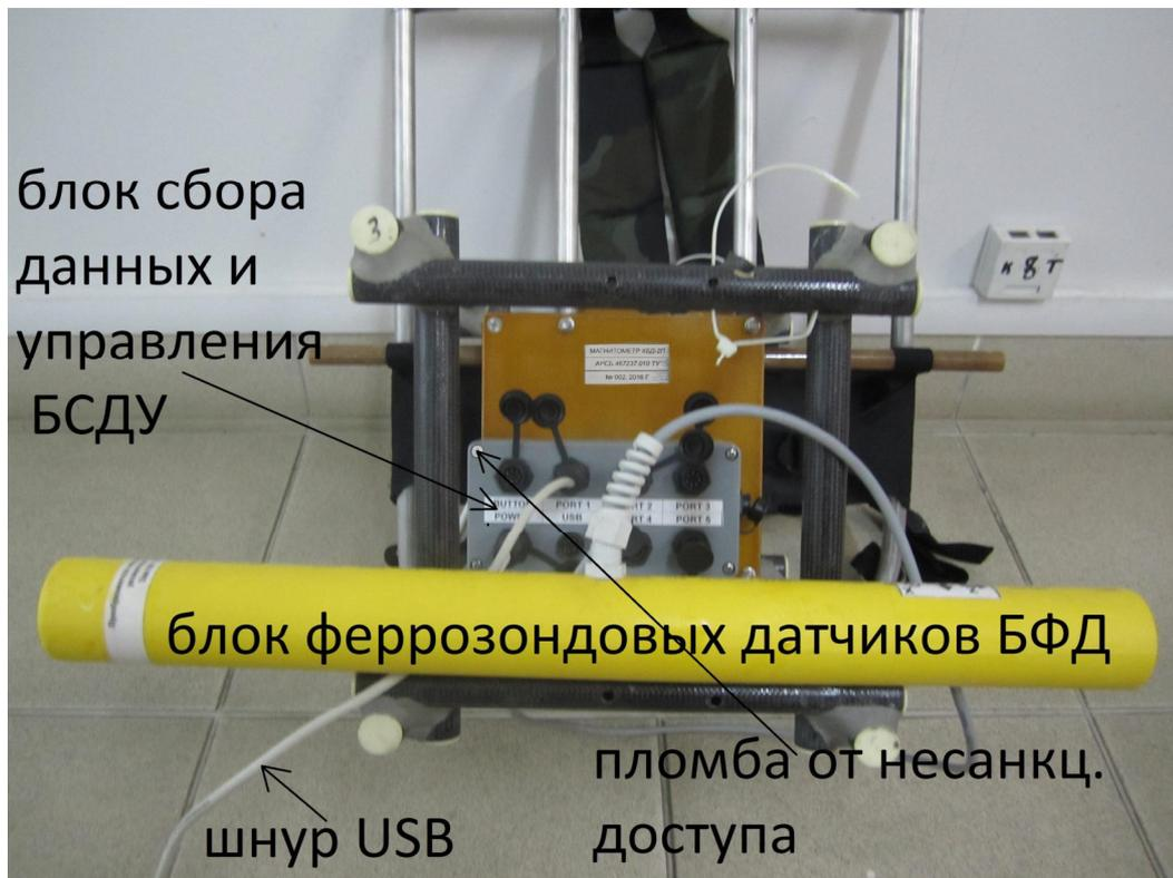
Рисунок 2 - Общий вид блока феррозондовых датчиков магнитометра с блоком управления и шнуром для подключения компьютера без защитного кожуха со схемой пломбировки от несанкционированного доступа
