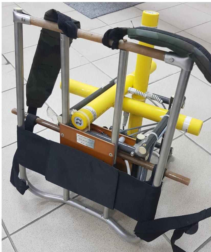
Рисунок 1 – Общий вид магнитометра (без кожуха)
