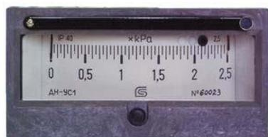
Рисунок 4 - общий вид тягомеров ДТ-УС, ДТ-Р, напоромеров ДН-УС, ДН-Р, тягонапоромеров ДГ-УС, ДГ-Р сигнализирующих, регулирующих и электроконтактных с одной уставкой
