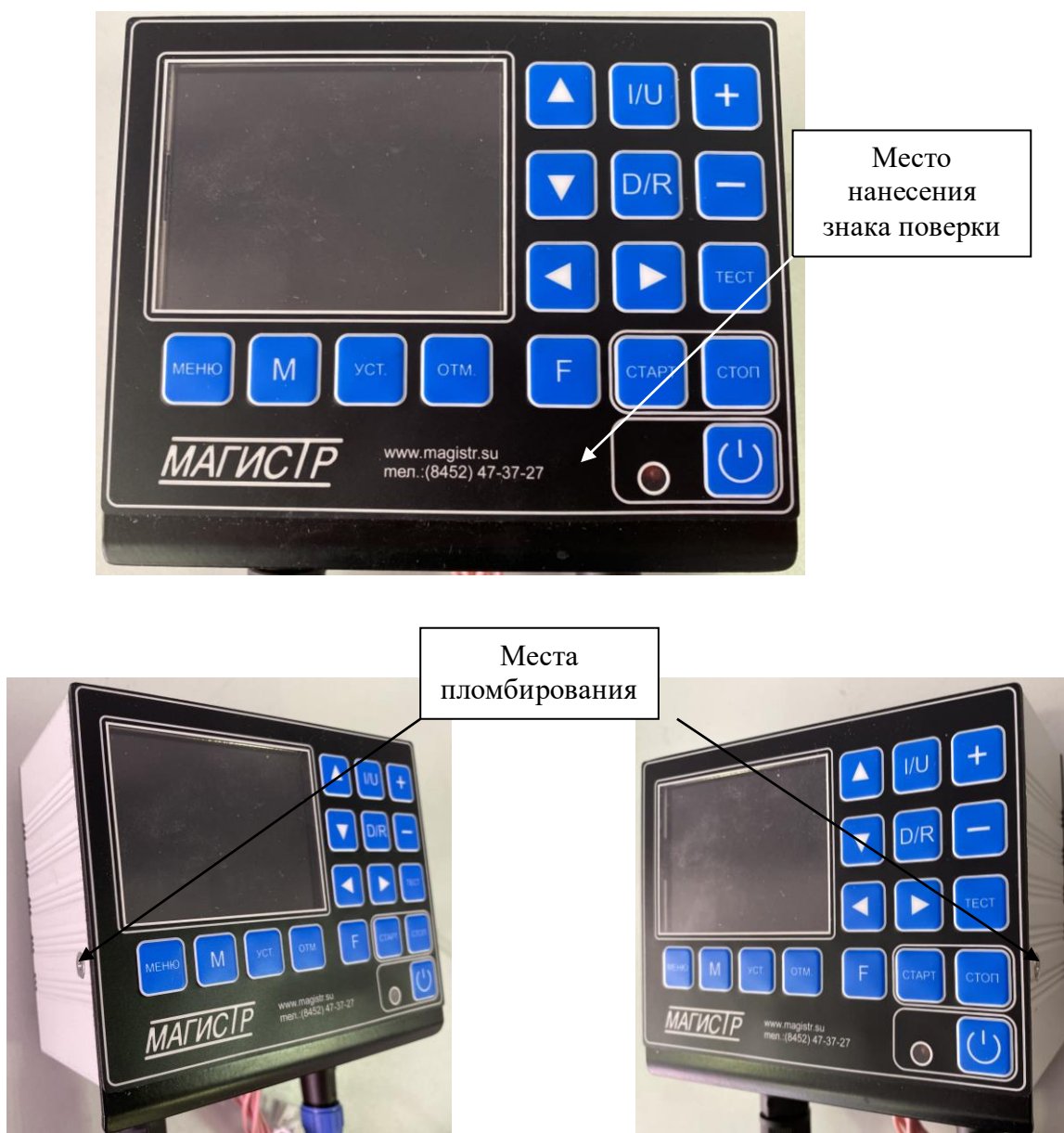
Рисунок 1 – Общий вид измерителей с указанием мест нанесения знака поверки и пломбирования от несанкционированного доступа
