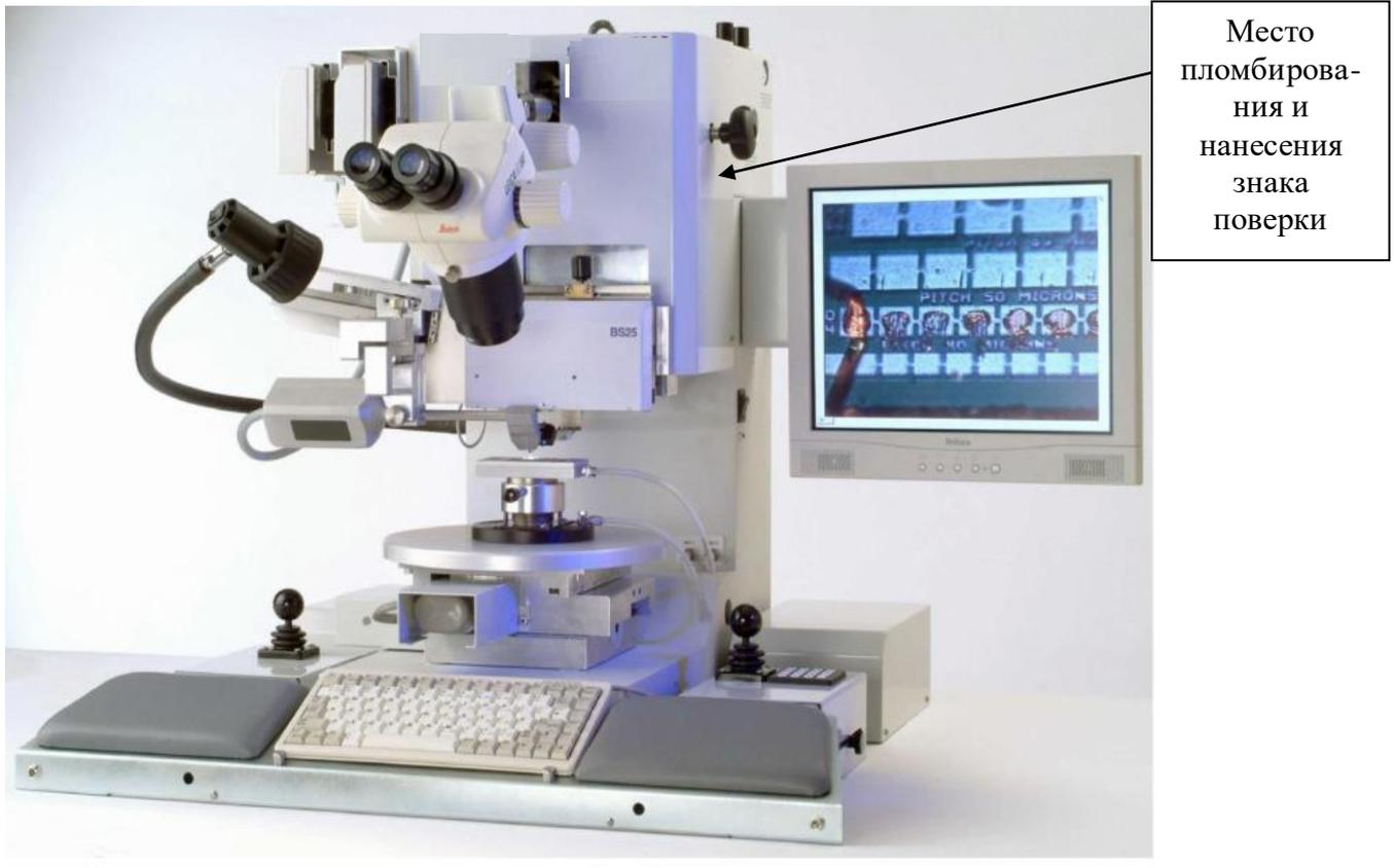
Рисунок 1 – Общий вид установки тестирования микросоединений ТМ-1
