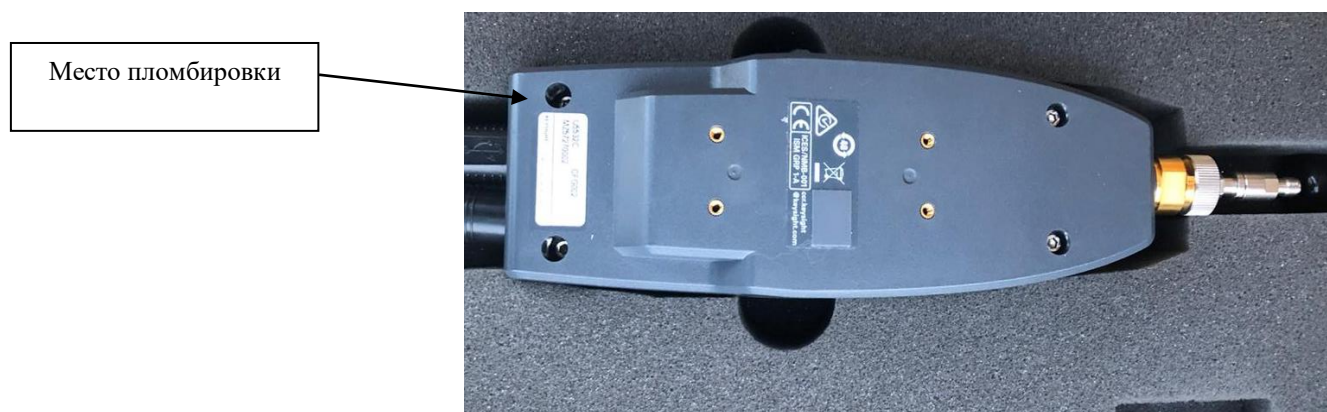
Рисунок 5 - Схема пломбировки преобразователя мощности USB U5532C
