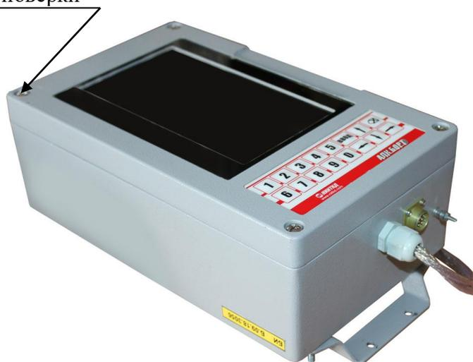
Рисунок 2 – Место нанесения знака поверки
