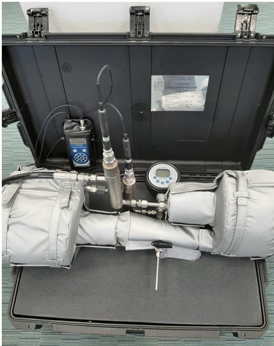
Рисунок 1 – Общий вид основного корпуса установки пикнометрической ГКС-УП
