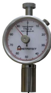
Рисунок 1. Общий вид твердомеров ТПШ- А (С, D) с аналоговым индикатором
