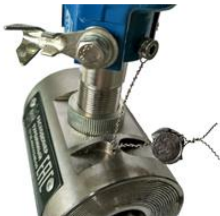
Рисунок 3 - Место установки пломбы
