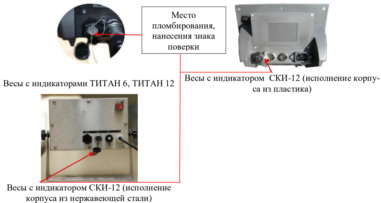
Рисунок 3 – Схема пломбировки от несанкционированного доступа, место нанесения знака поверки для весов
