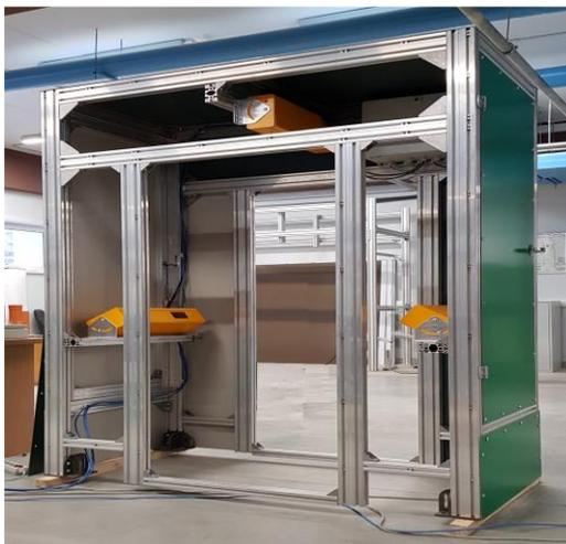
Рисунок 1 – Общий вид измерителей геометрических параметров бревен ВЕКТОР-3D
