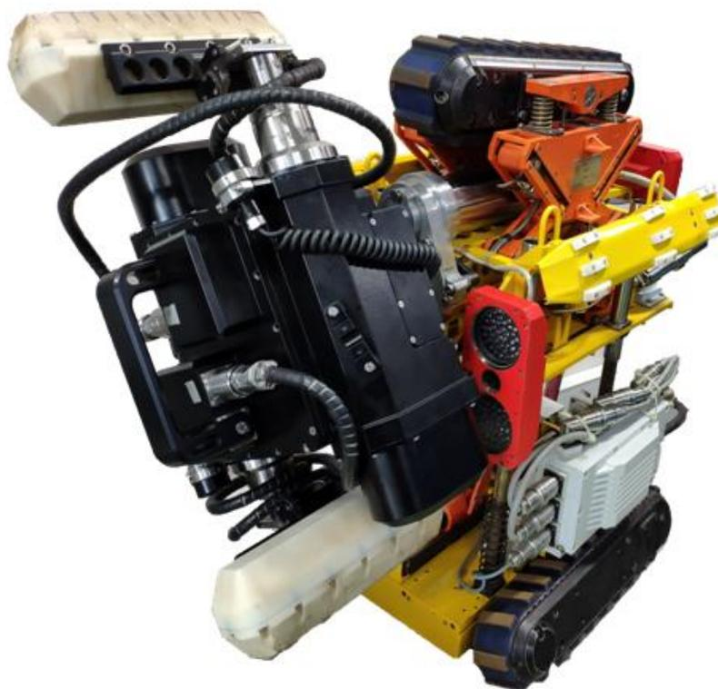
Рисунок 1 – Общий вид ММД-24 с ДИ-ММД при его установке на взрывобезопасное средство доставки
