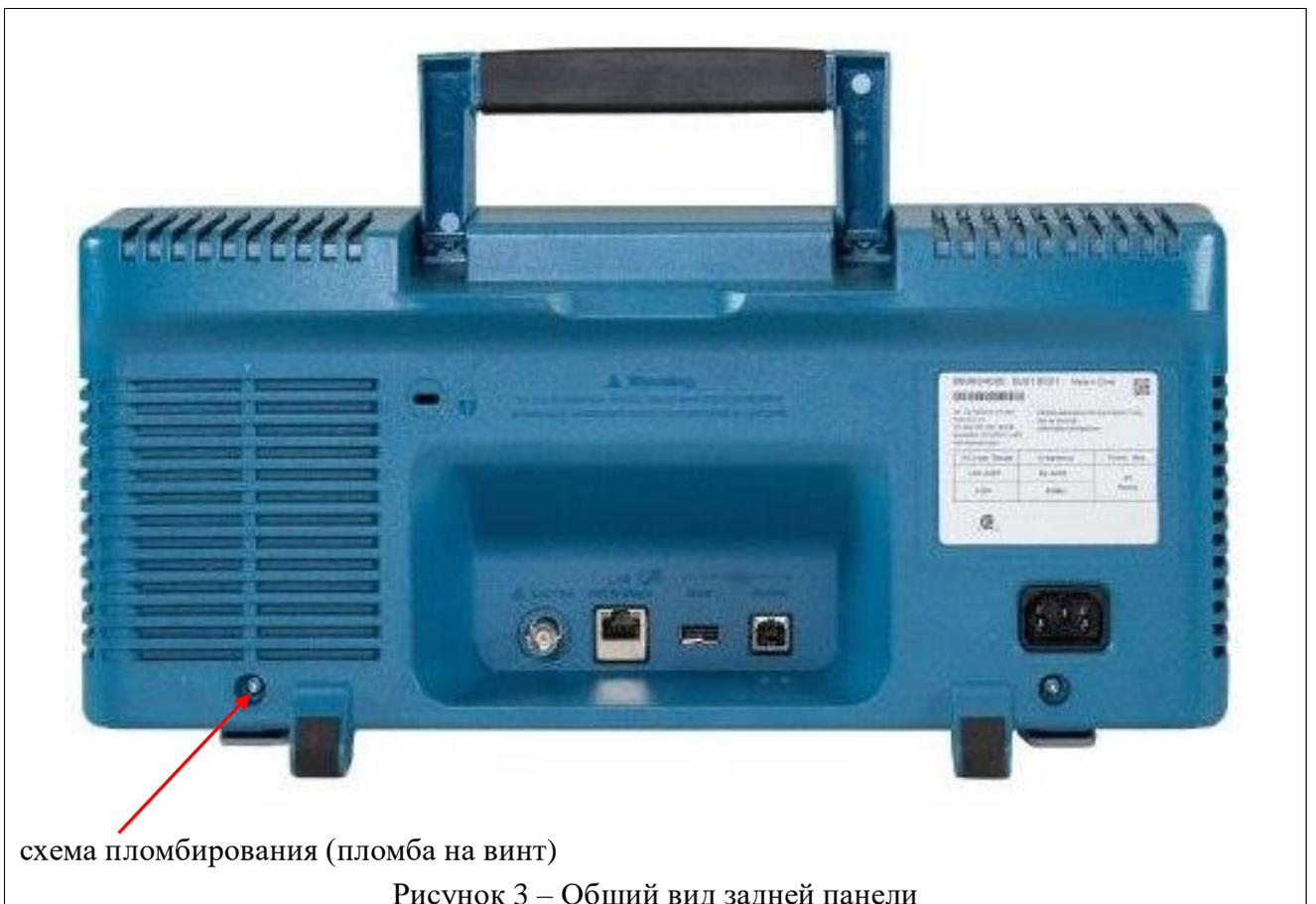
схема пломбирования (пломба на винт)
