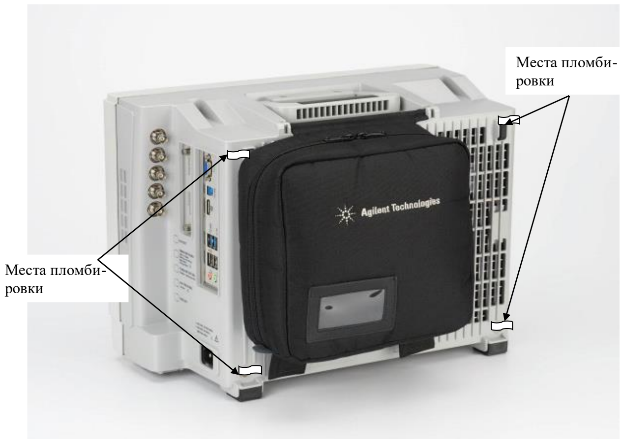
Рисунок 2 - Схема пломбировки от несанкционированного доступа
