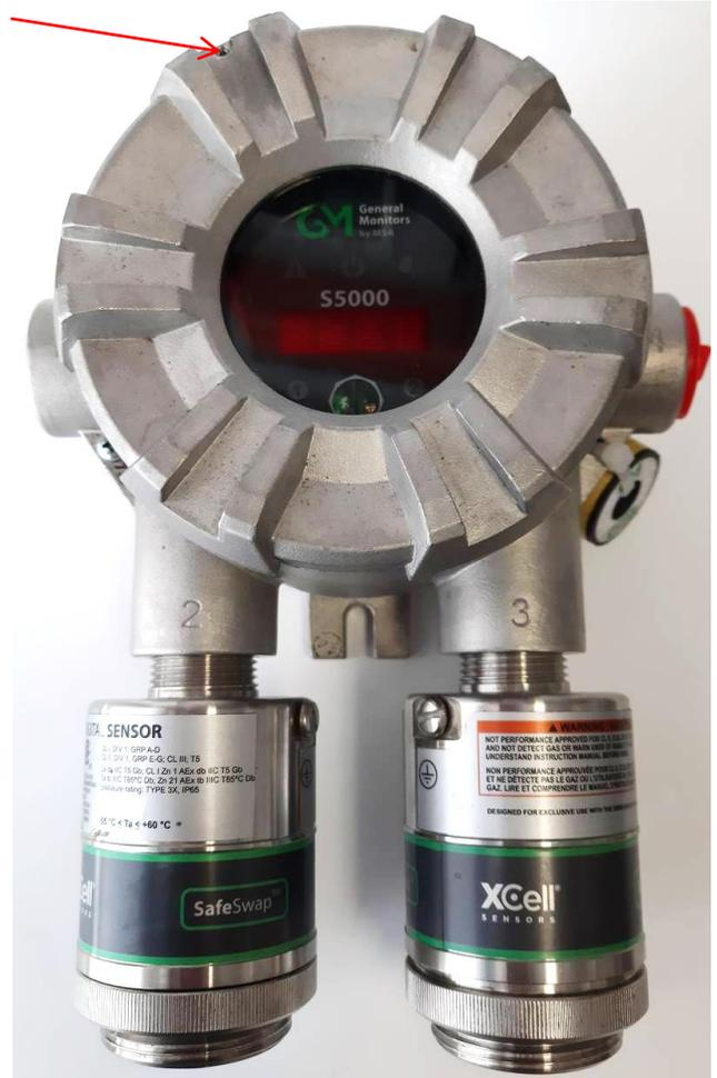
б) общий вид газоанализатора S5000 с двумя XCell Digital Sensor
