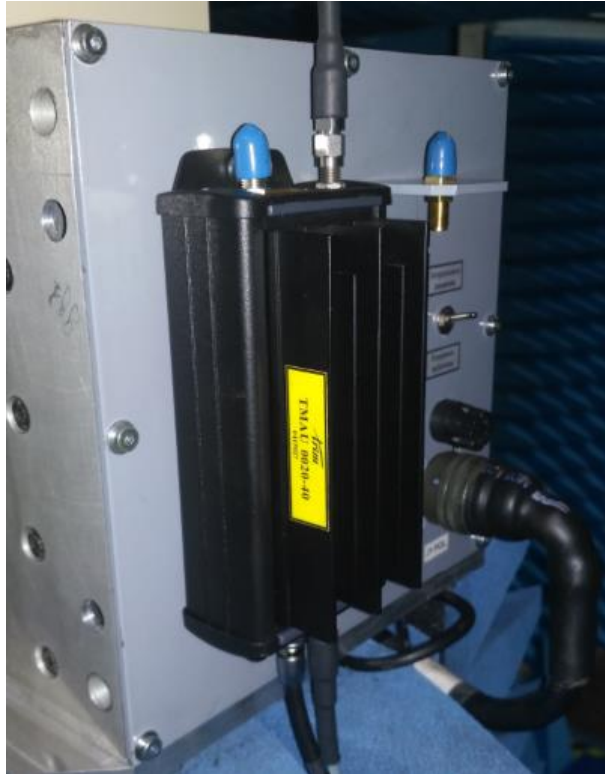
Рисунок 5 – Общий вид модуля малошумящего усилителя TMAU 0020-40
