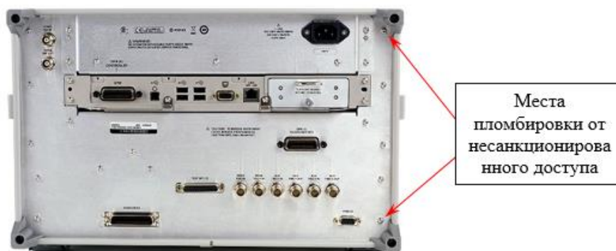
Рисунок 1 – Задняя панель векторного анализатора цепей N5232A с указанием мест пломбировки от несанкционированного доступа
