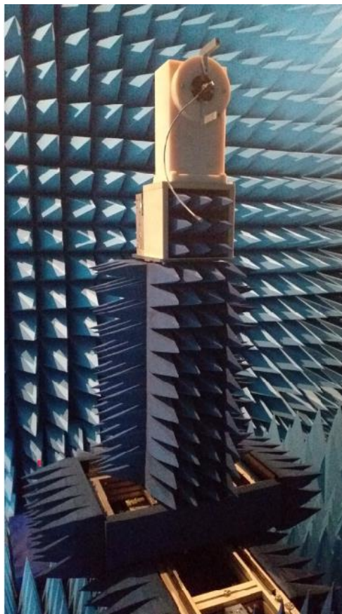
Рисунок 2 – Общий вид прецизионного опорно-поворотного устройства ТМП 04В. 020
