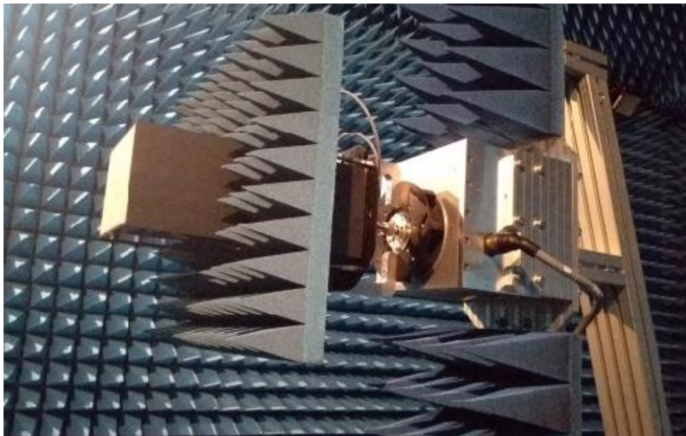
Рисунок 3 – Общий вид стойки вспомогательных антенн ТМП 01В. 018 с установленной антенной ТМА 1-40 В
