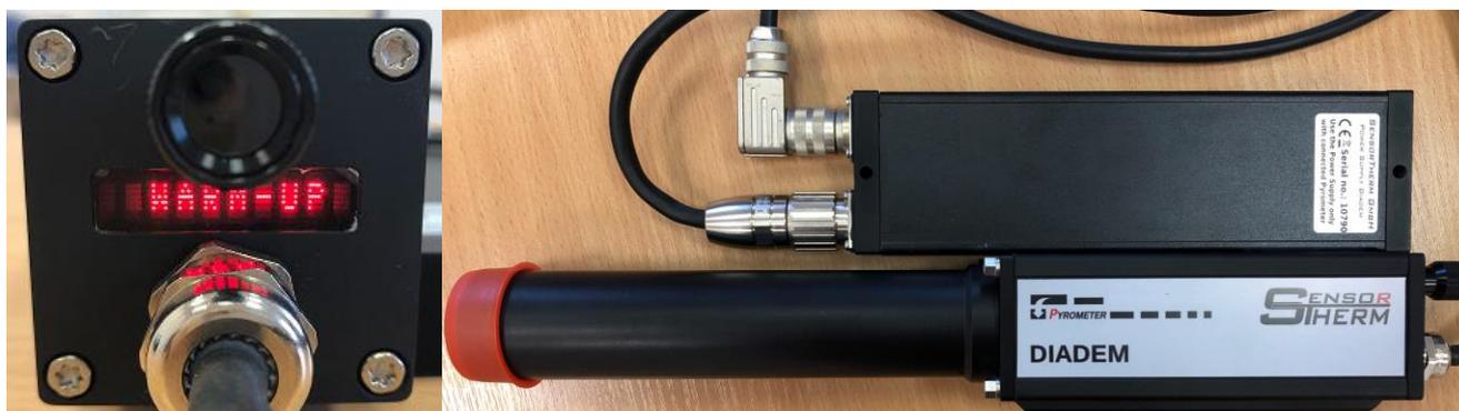
Рисунок 1 – Общий вид пирометра
