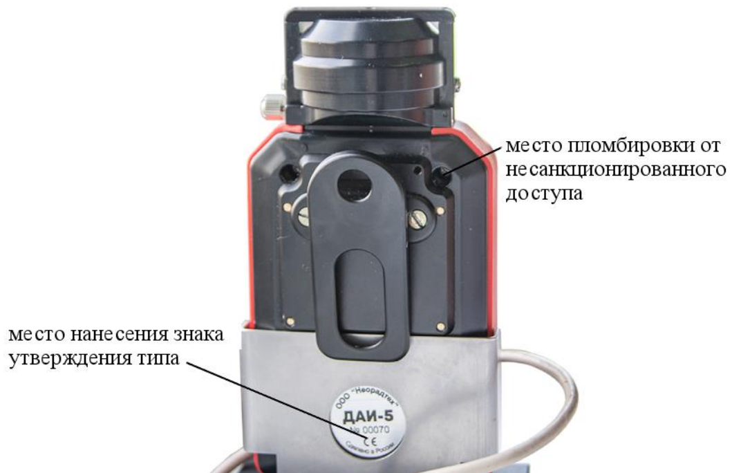
Рисунок 4 – Схема пломбировки от несанкционированного доступа, место нанесения знака утверждения типа
