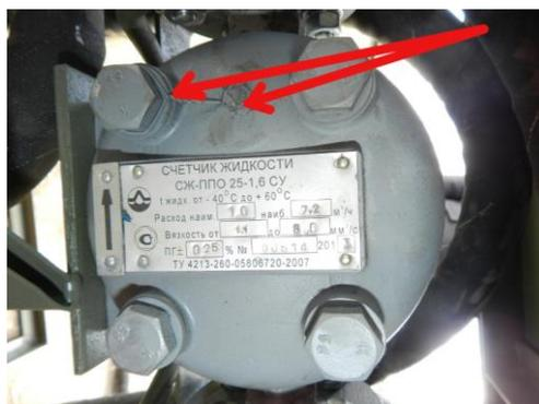
Рисунок 2 – Схема пломбировки счётчика жидкости колонок
