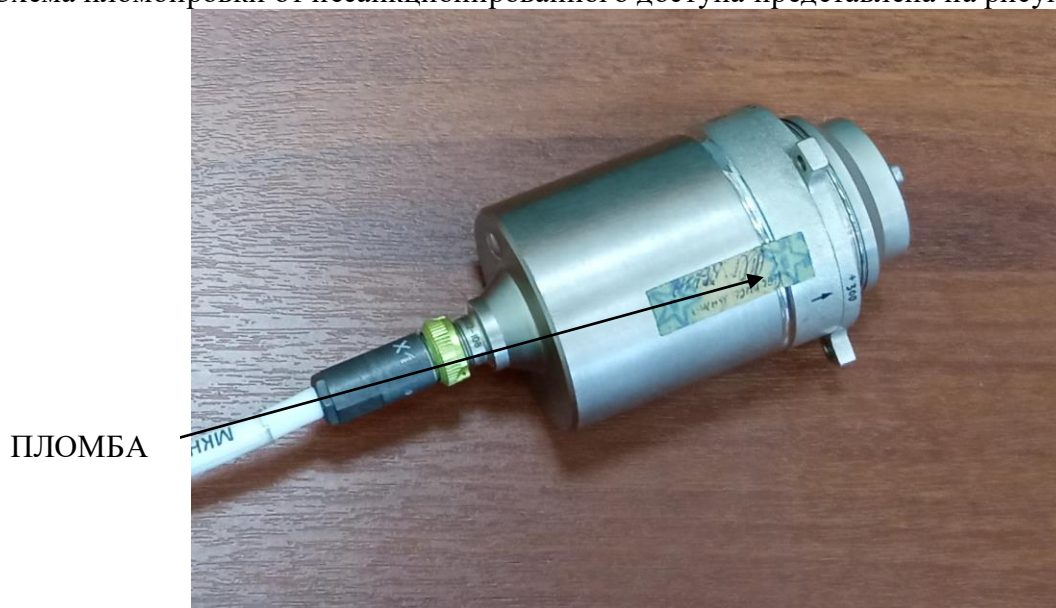
Рисунок 2 – Схема пломбировки от несанкционированного доступа
