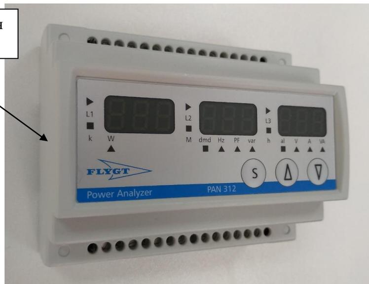
Рисунок 1 – Общий вид анализаторов с указанием мест нанесения знака поверки и пломбирования от несанкционированного доступа
