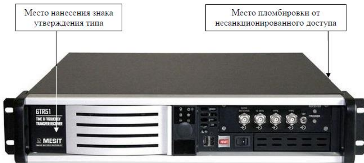
Рисунок 1 – Общий вид аппаратуры, схема пломбировки от несанкционированного доступа и обозначение места нанесения знака утверждения типа
