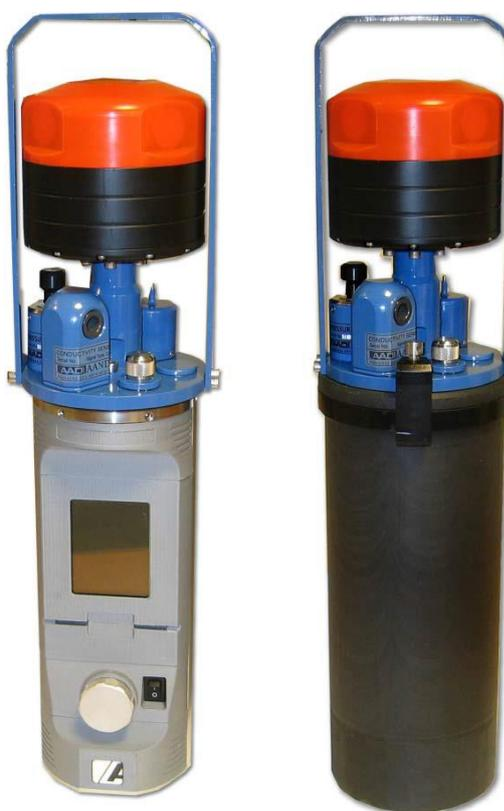
Слева - зонд SeaGuard RCM в режиме настройки (герметичный корпус демонтирован),
