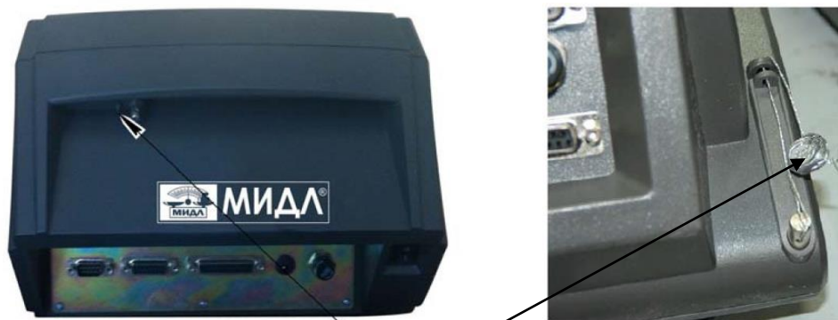
пломба с оттиском поверительного клейма
