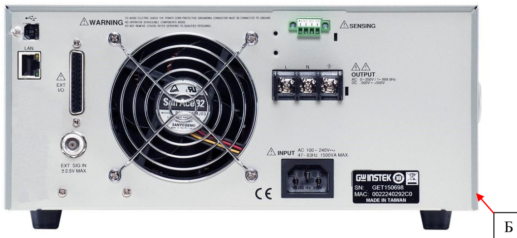
Рисунок 2 – Схема пломбировки от несанкционированного доступа (Б)
