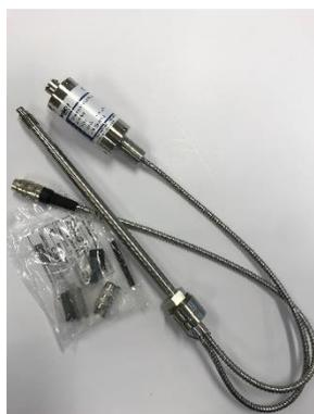
Рисунок 3 – Общий вид преобразователей модификаций ТДА410, ТДА412, ТДТ463Н, ТДТ432F.
