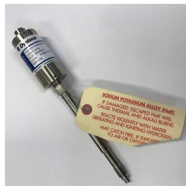
Рисунок 2 – Общий вид преобразователей модификаций РТ4226, РТ4626, РТ4206, РТ4226; РТ4204, РТ4224, РТ4604, РТ4624; РТ460Е, РТ462Е, РТ420А, РТ422А, РТ422А, ТРТ463Е.
