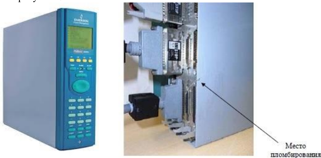
Рисунок 1 – Общий вид контроллера и схема пломбировки от несанкционированного доступа
