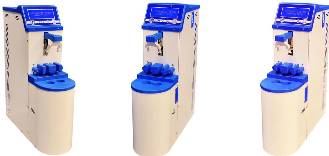
а) б) в) Рисунок 1 – Общий вид приборов для определения числа падения ПЧП-М а) ПЧП-3; б) ПЧП-7; в) ПЧП-Etalonik
