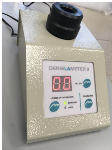
Рисунок 1-Общий вид приборов Densi-La-Meter II Пломбирование прибора не предусмотрено.
