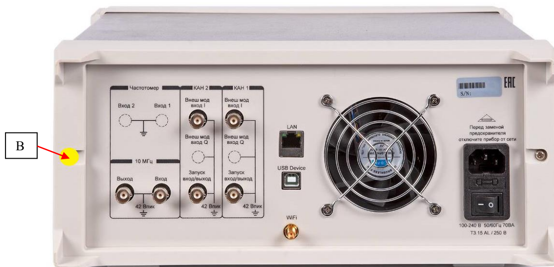
Рисунок 3 – Вид задней панели двухканальных модификаций генераторов и место опломбирования от несанкционированного доступа (B)
