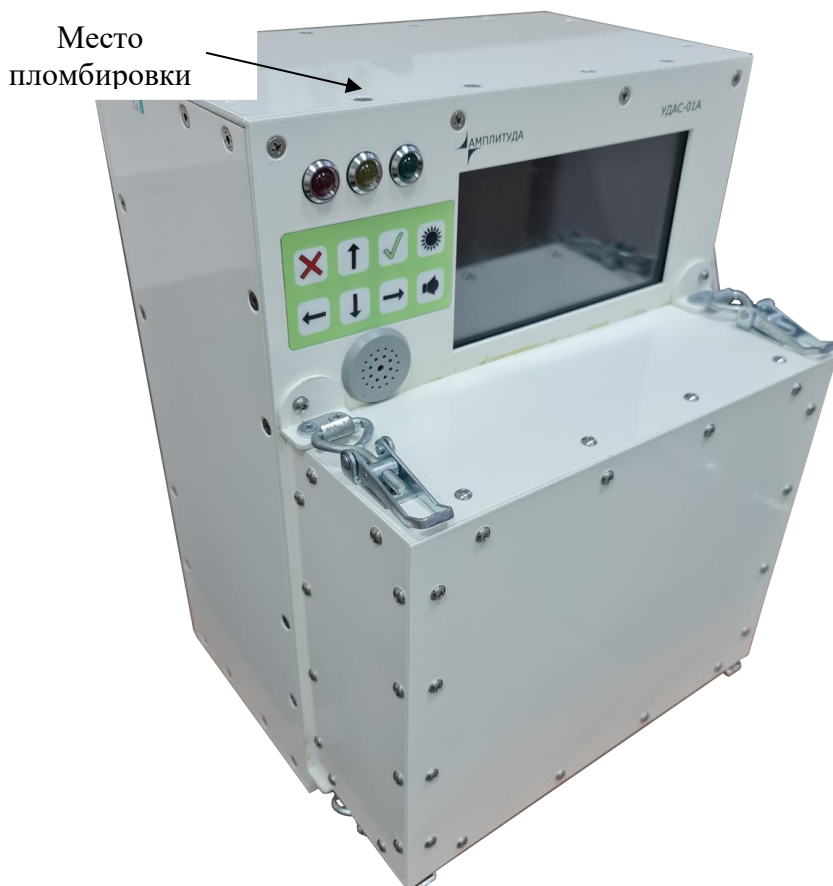
Рисунок 1 – Общий вид установки и схема пломбировки от несанкционированного доступа
