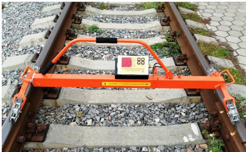
Рисунок 1 – Общий вид устройств для контроля рельсовой колеи (тележек путеизмерительных) ПТ-7МК
