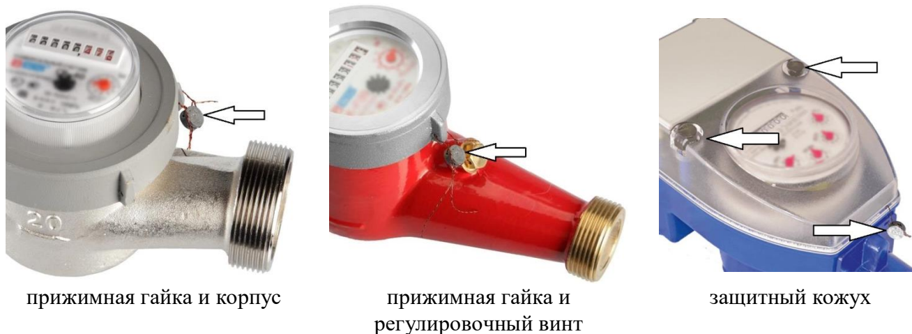
Рисунок 6 – Схема пломбировки от несанкционированного доступа, обозначение места нанесения знака поверки счетчиков показан стрелкой
