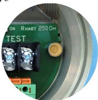
Рисунок 2 – внутренняя пломба на винте клеммной колодки
